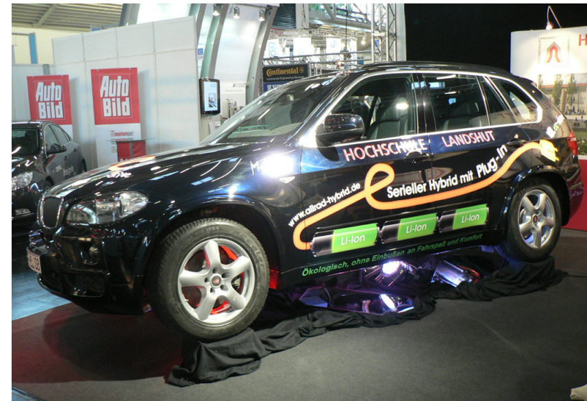
Serieller Plug-in-Hybrid auf Basis eines BMW X5
